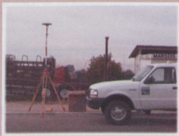
Figura 3. Procedimiento de monitoreo de la estación 24 con GPS; la altura de la antena se aumentó en razón de los obstáculos que representan las edificaciones cercanas, las mediciones se hacen en modo estático con una ocupación de tres horas a un intervalo de registro de 15 segundos.
